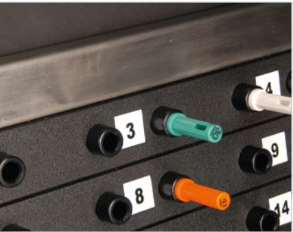
Jedem Mitarbeiter wird eine Bedienerstecker-Farbe zugeordnet. So kann jederzeit nachvollzogen werden, welcher Mitarbeiter gerade welchen Schlüssel in Gebrauch hat.
